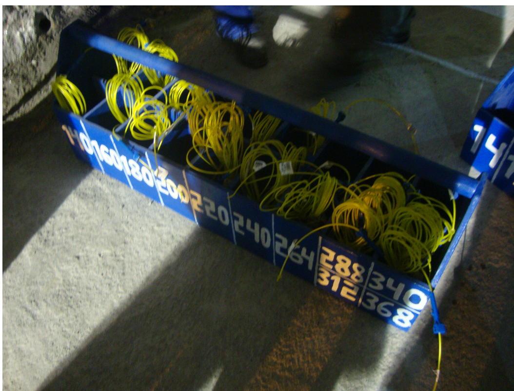
Figura 21. Acessórios transportados separado dos explosivos. Fonte: Acervo da empresa.
