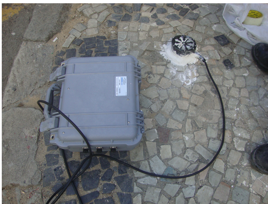
Figura 33. Sismógrafo de engenharia instalado. Fonte: Acervo da empresa.
